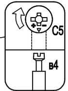
Ориентация стяжки C5 – показана на рис., после сборки с дюбелем B4 стяжку затянуть по стрелке
